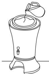
16. La primera vez que llenes el purificador, deberá pasar por un proceso de saturación, lo que hará que la filtración sea un poco lenta durante los primeros 3 días. Asegúrate de mantener el purificador ecofiltro lleno, para acelerar este proceso.
